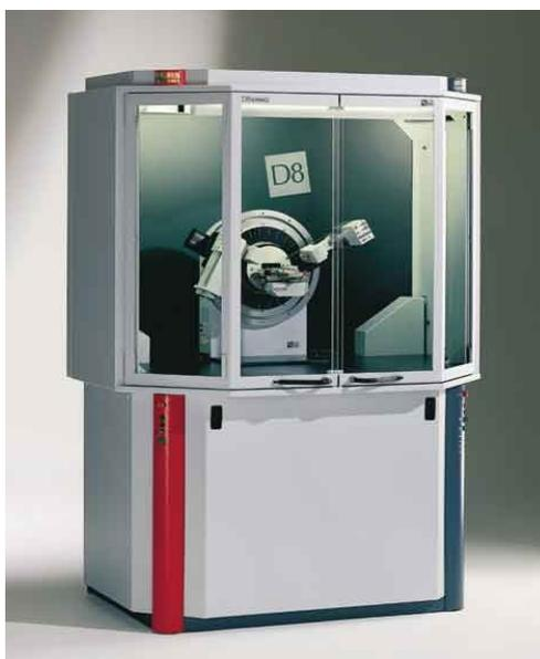
Рис. 5. Внешний вид дифрактометра рентгеновского D8 ADVANCE фирмы «Bruker»
