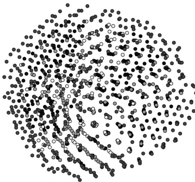
Рис. 1. Аморфноподобная структура кластера  $Ni$  ( $D=2,9$  нм) с зародышем икосаэдрической фазы, полученная при времени охлаждения  $t=0,2$  нс
