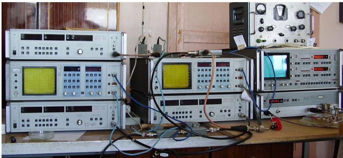
Рис. 1. Установка для измерения диэлектрических свойств нанокompозитов в диапазоне от 2 до 18 ГГц
