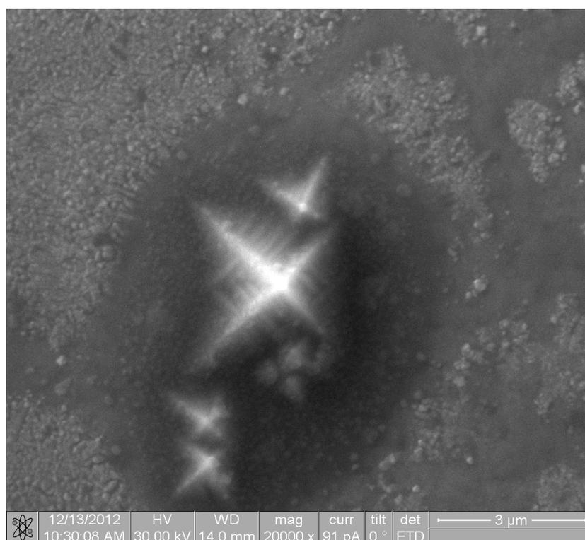
Рис. 4. Дендритный кристалл на поверхности нержавеющей стали.
