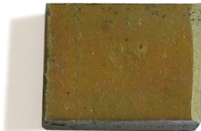
Рис. 1. Фотография образца нитрита титана, нанесённого на подложку из нержавеющей стали.
