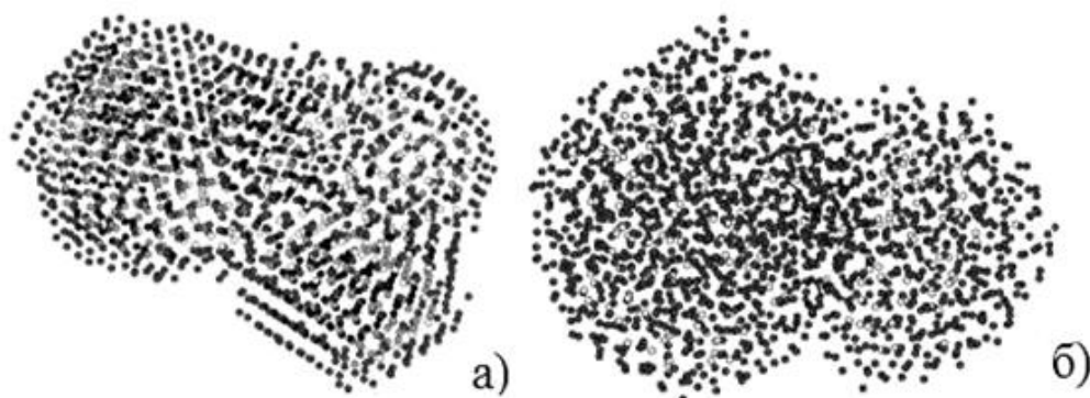
Рис. 2. Эволюция кластера Cu_{1771} в зависимости от температуры нагрева: а) T = 100 К, б) T = 1200 К.
