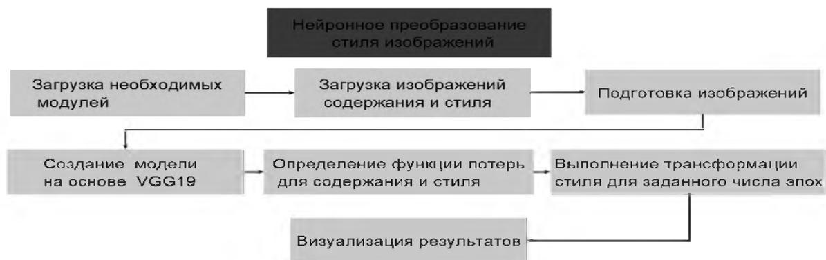
Рис. 1. Примерная структура алгоритма нейронного преобразования стиля изображений в облаке GoogleColabc применением модели VGG19 [3]
