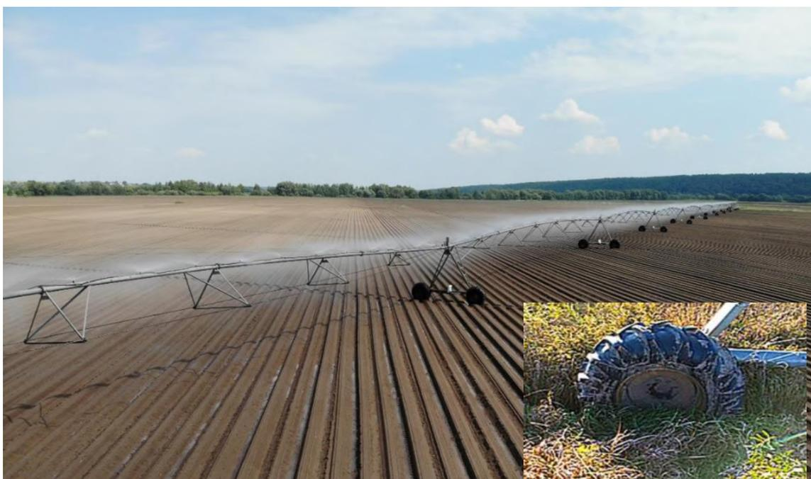
Рис. 1. Общий вид ДМ «Кубань-ЛК1» на склоновом участке с колееобразованием на последней тележке
